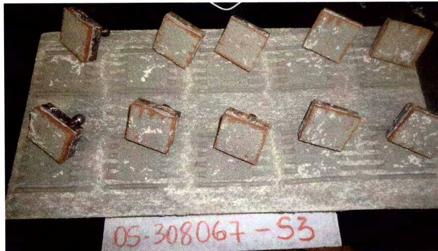
FOTO(03) - Ensaio de Aderência cura estufa
