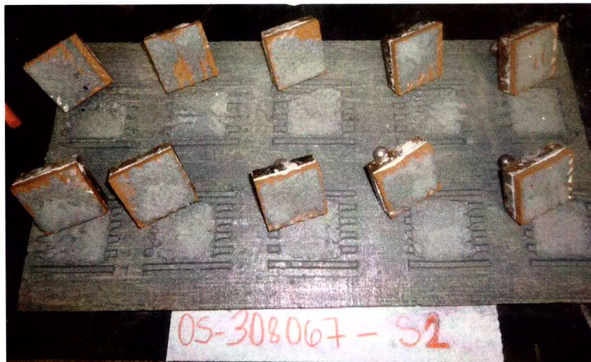
FOTO(02) - Ensaio de Aderência cura submersa
