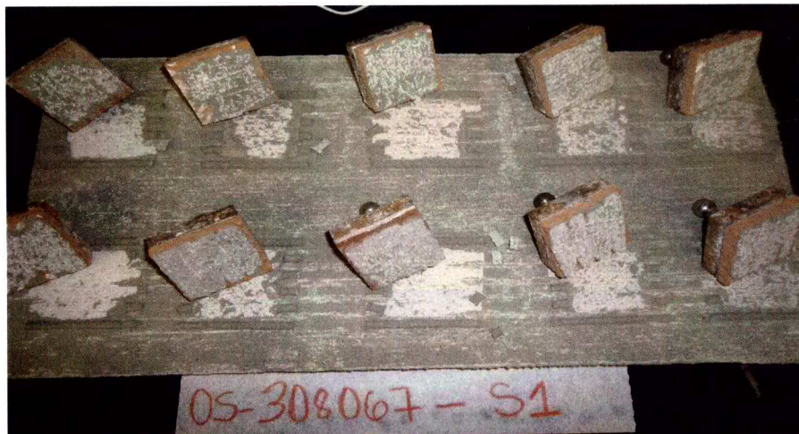
FOTO(01) - Ensaio de Aderência cura normal
